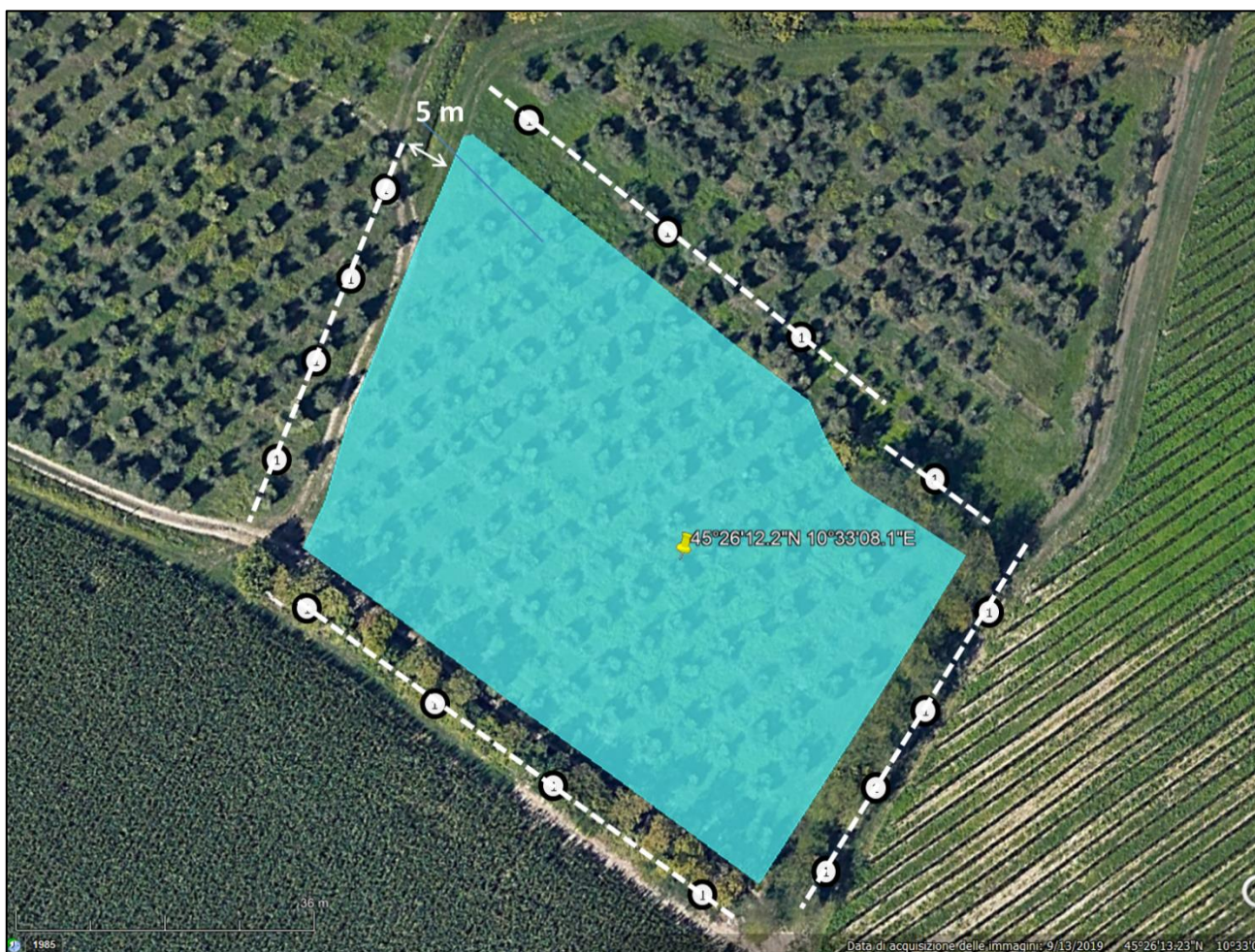
Figura 6. Disposizione dei dischi di carta da filtro, contenuti in capsule Petri, per la determinazione della deposizione a terra della s.a. per la valutazione dell'effetto deriva.
