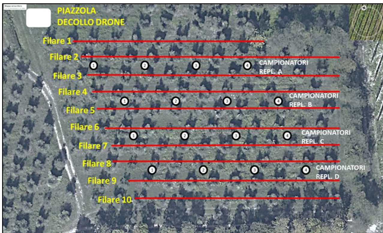
Figura 5. Disposizione dei dischi di carta da filtro, contenuti in capsule Petri, per la determinazione della deposizione a terra della s.a. (anno 2023).
